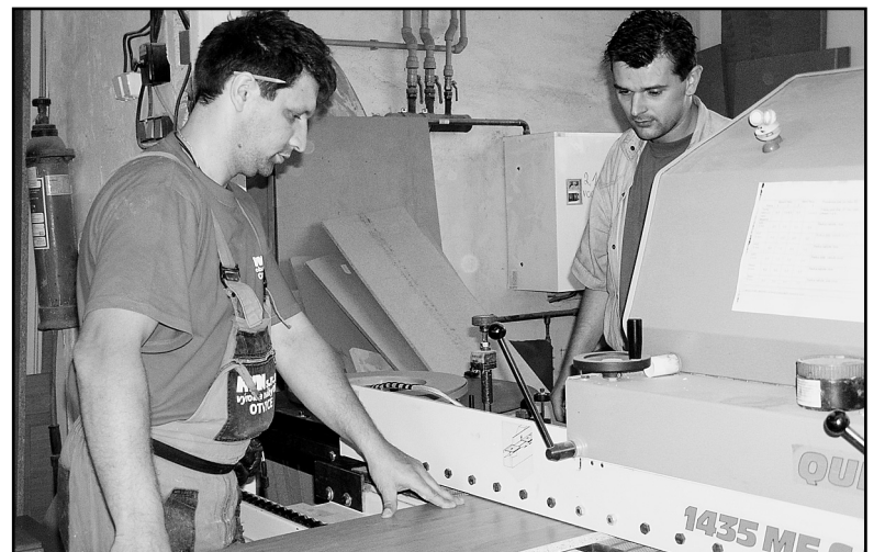
Vestavná skříň má tu výhodu, že dokáže perfektně zvětšit danou místnost. Na snímku Desider Lacko (vlevo) a Jiří Mezulánik lepí pomocí speciálního stroje hranu na jednotlivé formáty desek u skříní. (foto: mile)
