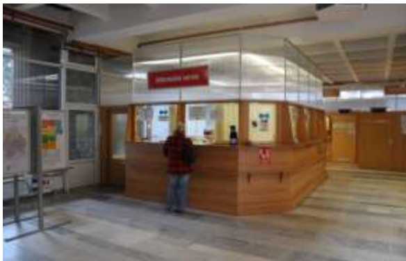
Pracoviště ve vstupní hale chrání před hlukem a průvanem vyvýšené stěny.
