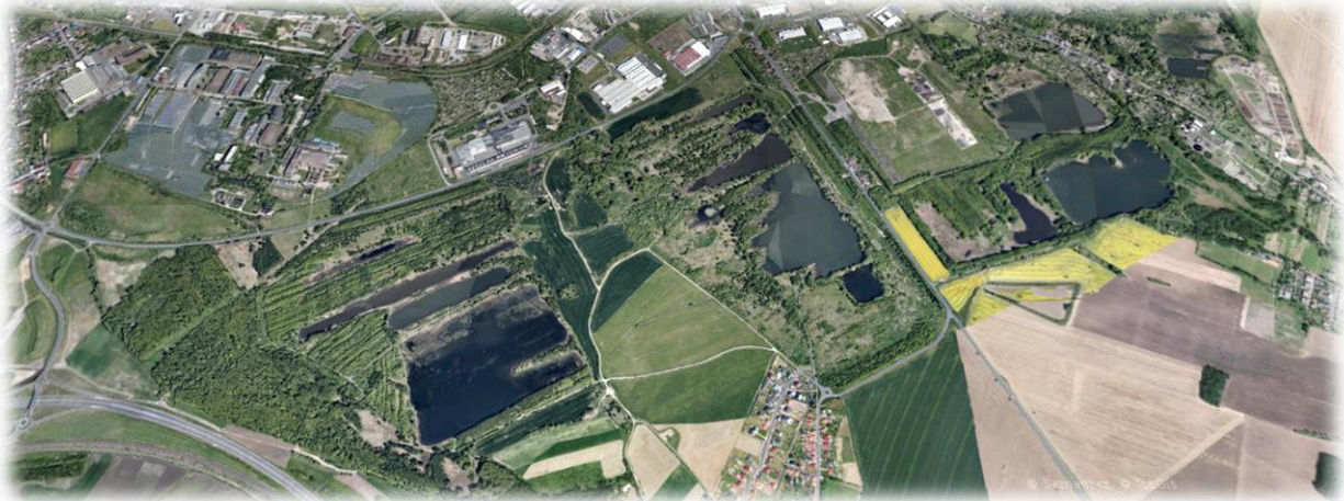
Obr.: Pražská pole – pokles půdy v důsledku hlubinné těžby.
