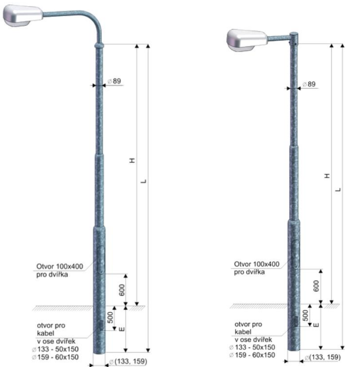
Obr. 9 - Technické specifikace stupňovité stožáry kulaté pro výšku 8-12 m
