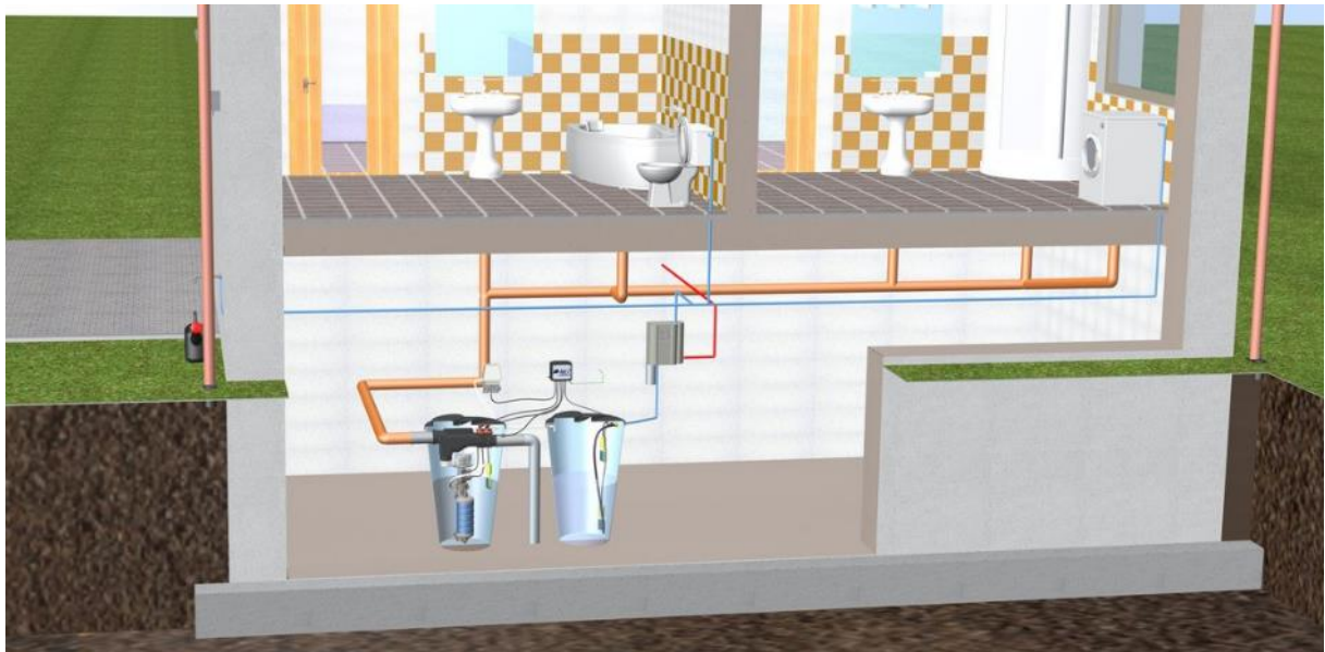
Obrázek 37 Schématické zobrazení využití šedých vod
