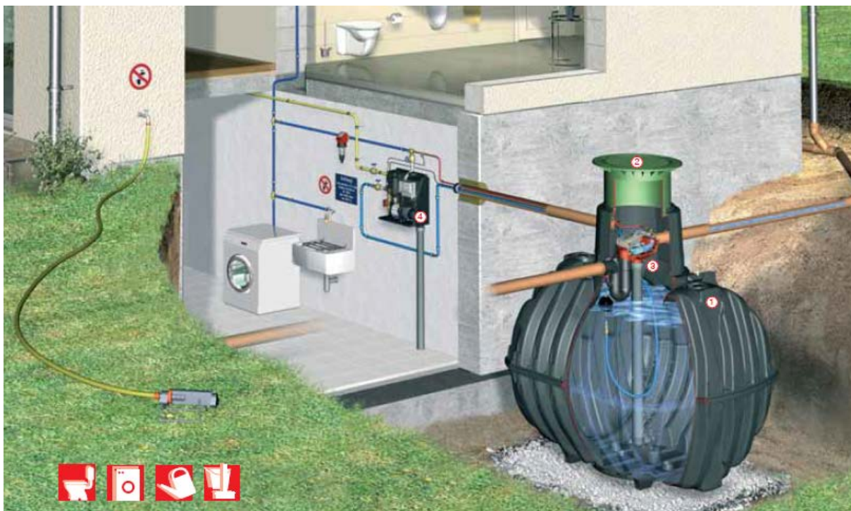
Obrázek 36 Systém pro využití srážkové vody na zálivku, splachování WC a praní
