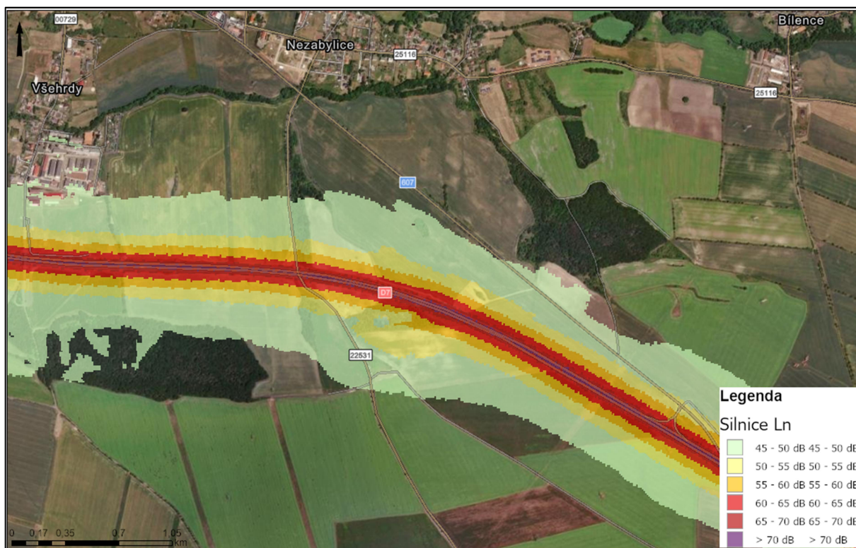
Obrázek 18. Hodnoty hluku z dopravy na D7 v noční době (hlukové mapy 2022, geoportál Ministerstva zdravotnictví).
