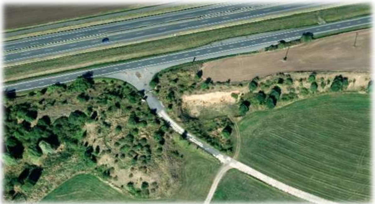
Obr: Detail vstupní části pro dopravní obsluhu ploch Z1/1. Napojení vyžaduje komplex staveb zajišťujících bezpečné oboustranné odbočení ze silnice II/607, úpravu sklonu komunikace a upevnění terénní hrany s otevřenou pískovou stěnou. Sestupná část přístupové komunikace překračuje trasu regionálního biokoridoru LBK 583 prostřednictvím kapacitního mimoúrovňového křížení.
