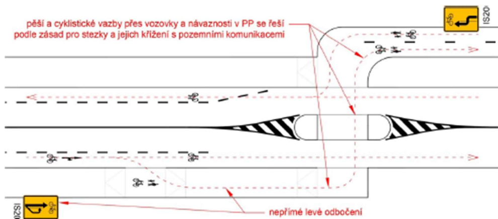
Obrázek 76: Příklad napojení stezky na vozovku s nutností zastavit, s využitím nepřímého levého odbočení dle TP 179
